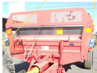
後部反射器及び灯火器類の設置例
