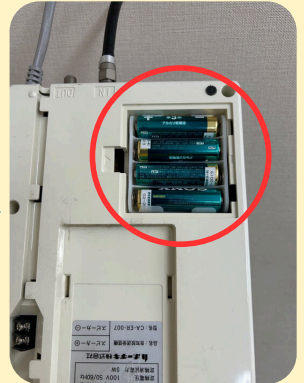
④ 端末機の裏側から乾電池4本を取り出します。
