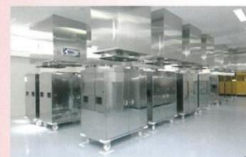
④ 電気式天吊りコンテナ消毒装置
