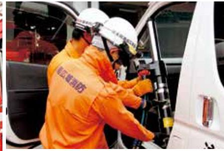
活動スペースを拡張し、安定させることができるラムシリンダー。交通救助などで車のフロント部分が大きく変形し、ドライバーが挟まれている場合などで使用する。
