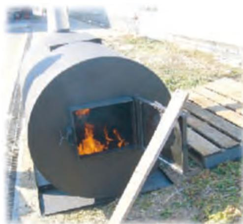
固形燃料の燃焼実験の様子
