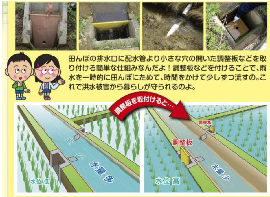
図 5.5 水田を活用した雨水貯留の事例（農林水産省資料より）
