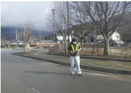
【電子式漏水発見器による調査】
