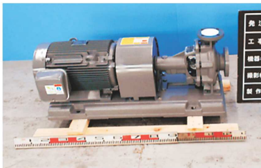
【高効率ポンプの工場製作】
