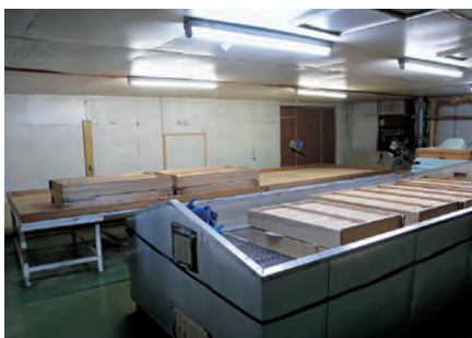
左：普通酒の仕込みに使用している大型の連続蒸米機
