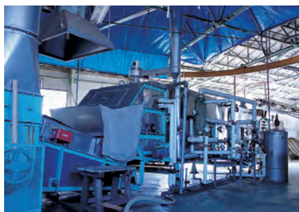
左：普通酒の仕込みに使用している大型の連続蒸米機
